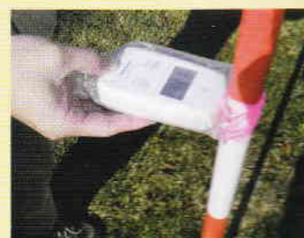
定規やひもに目印を付けて表面からの高さを測りながら測定します。
