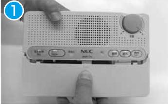
1 電池のフタの「▼」の部分を下に押しながら、フタを外します。
