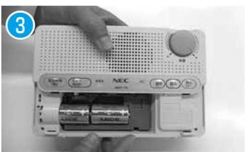
3 ⊕⊖の方向を確認し、乾電池を交換します。
