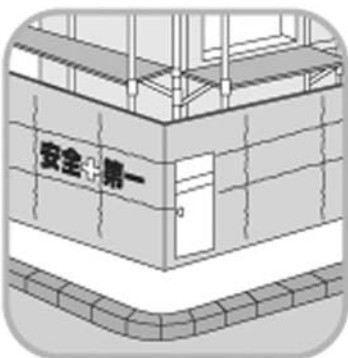
▲工事用仮囲等を設置する
