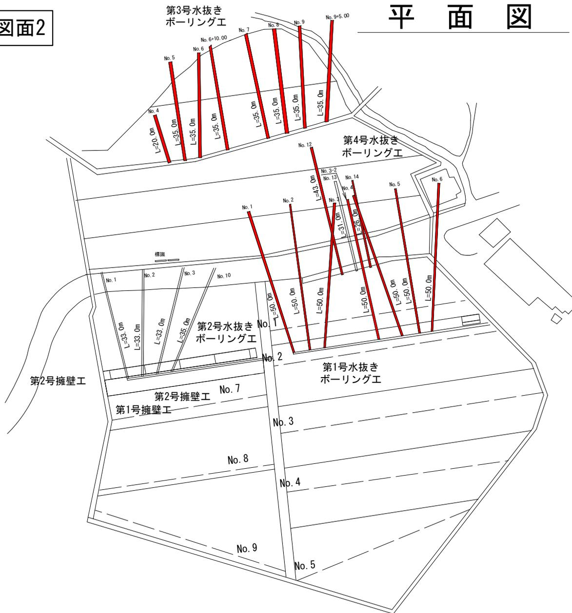
水抜きボーリング孔更新工 合計 N=17本
